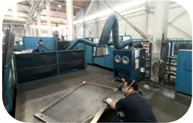
於焊接工序中設置高效的抽風設備及為員工配備適當的勞工用品
